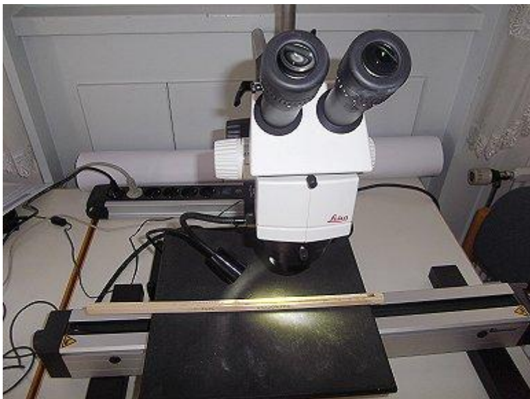
Am Messtisch mit Mikroskop werden die Bohrkernringe ausgezählt
